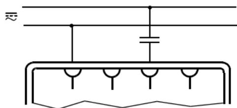
La componente in tensione continua, presente ad esempio nello stadio finale di un amplificatore, può essere separata tramite un condensatore (valore raccomandato:  $4,7\ \mu\text{F}/630\text{ V}$ ). Alla frequenza di misura 50 Hz, l'errore di misura addizionale resta inferiore allo 0,2 %. La misurazione stessa si effettua nel modo sovradescritto.
