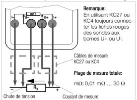
Les pinces Kelvin KC4 et les sondes Kelvin KC27 proposées comme accessoires permettent une connexion simple et correcte.
