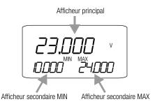
Alors que l'afficheur principal apparaît dès que le multimètre est allumé, il faut activer les deux afficheurs secondaires en appuyant sur la touche DATAI CLEAR (sauf en position  $M\Omega@...V$ , où les afficheurs secondaires apparaissent dès que la fonction a été sélectionnée).
