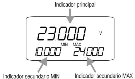
Mientras que el indicador principal se visualiza inmediatamente después de activar el multímetro, ambos indicadores secundarios deben activarse pulsando la tecla DATA|CLEAR. (Excepto en la posición M $\Omega$ @...V, en la que los indicadores secundarios se visualizan inmediatamente después de seleccionar la función)
