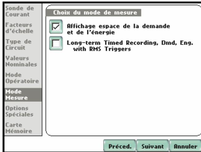
Le MAVOWATT 20 dispose des modes de mesure suivants: enregistrement périodique de longue durée des mesures de la puissance et de l'énergie, sans ou avec déclencheur RMS. La sélection d'une variante de réglage définit automatiquement les conditions d'enregistrement et du déclencheur. Les utilisateurs expérimentés peuvent modifier les réglages comme il le souhaite (voir chapitre 6 options de configuration avancée).
