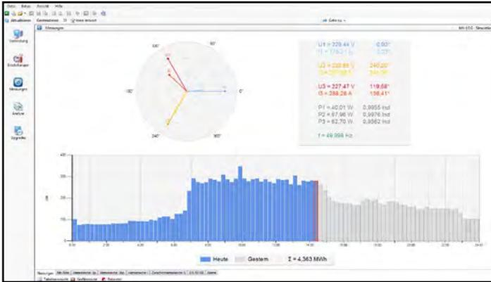
Vektordiagramm sowie Multimeterfunktion (obere Bildschirmhälfte) informieren über den aktuellen Belastungszustand. Das Balkendiagramm (untere Bildschirmhälfte) zeigt den bisherigen und den zu erwartenden Tageslastgang.
