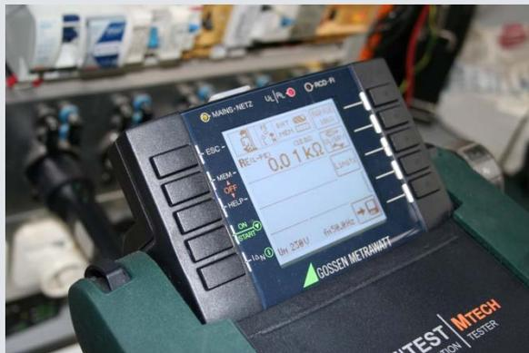
Beispiel einer  $R_{E(L-PE)}$  Messung- 2-Pol-Messung mit 2-Pol-Adapter
