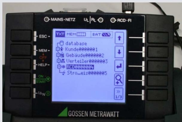
Anlegen einer Prüfdatei mit Hilfe der ETC Software
