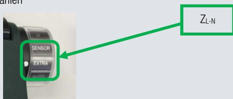
2. Anschluss Schuko. Für den Korrekten Anschluss drücken Sie die Taste
