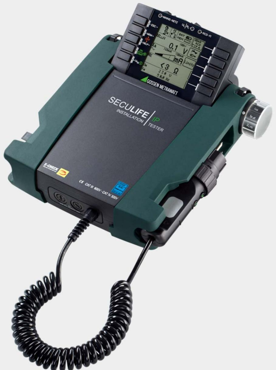
Der SECULIFE IP kann alle Prüfungen der Wirksamkeit von Schutzmaßnahmen in elektrischen Anlagen durchführen, wie sie in der IEC 60364-4 / VDE 0100-600 gefordert und in den einzelnen Abschnitten der EN61557 / VDE 0413 definiert sind. Es ist damit optimal für Abnahme- und Wiederholungsprüfungen an ortsfesten elektrischen Installationen geeignet. Mit Messkategorie CAT IV bietet der SECULIFE IP dem Anwender die höchstmögliche Sicherheit.
