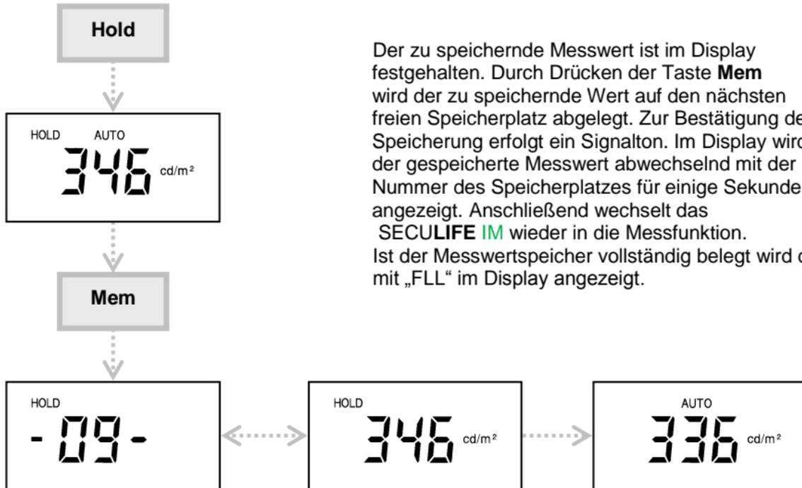
Der zu speichernde Messwert ist im Display festgehalten. Durch Drücken der Taste **Mem** wird der zu speichernde Wert auf den nächsten freien Speicherplatz abgelegt. Zur Bestätigung der Speicherung erfolgt ein Signalton. Im Display wird der gespeicherte Messwert abwechselnd mit der Nummer des Speicherplatzes für einige Sekunden angezeigt. Anschließend wechselt das **SECULIFE IM** wieder in die Messfunktion. Ist der Messwertspeicher vollständig belegt wird dies mit „FLL“ im Display angezeigt.
