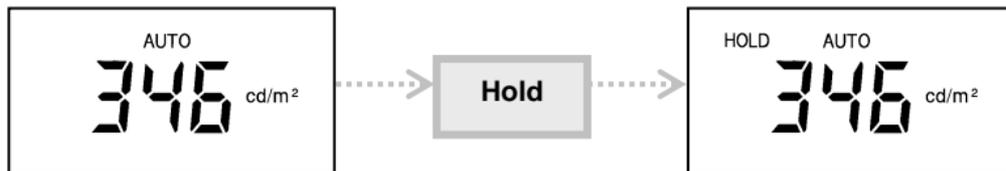
Die Funktion „Hold“ ist die Ausgangsfunktion für alle Speicherfunktionen.
