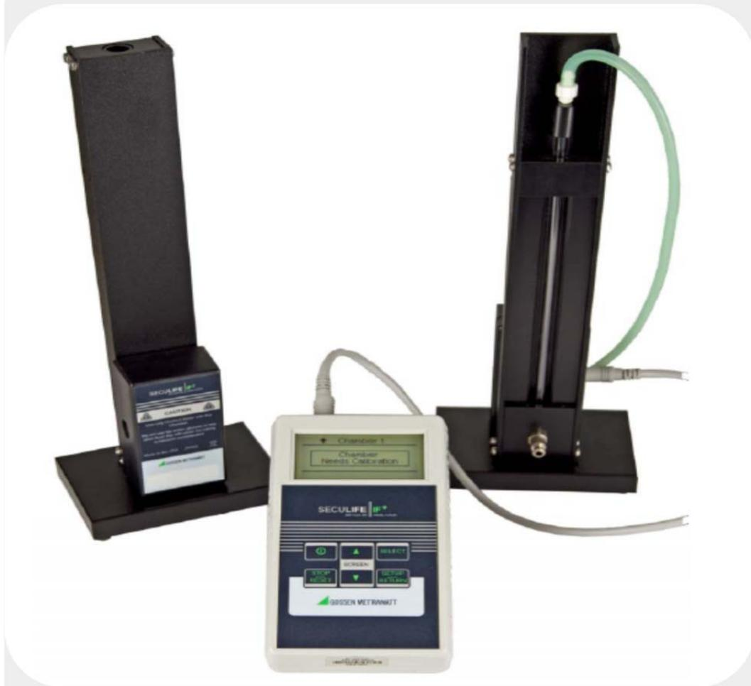
Der SECULIFE IF+ ist ein mikroprozessorgesteuerter, hochpräziser Infusionspumpen Analysator (IPA) zum Testen der Durchflussleistung von intravenösen Infusionspumpen. Das Gerät kann gleichzeitig die Ausgangs-Durchflussleistung von zwei volumetrischen Pumpen unter Verwendung von volumetrischen Kammern testen. Nachfolgend sind die mitgelieferten Einzelteile kurz beschrieben und dargestellt.
