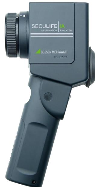
Der SECULIFE IA ist ein Präzisionsmessgerät mit einem Messwinkel von 1°. Mit diesem Gerät können Sie Leuchtdichtemessungen in einer Entfernung von 1 m bis  $\infty$  durchführen.
