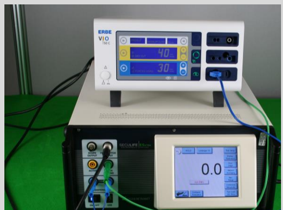
Abbildung: Neutralelektrode geerdet, Typ CF 1b z.B. Monopolar
