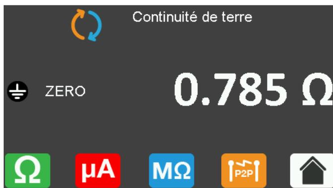
Le SafeTest 60 lance automatiquement le test dès qu'il est sélectionné et l'interrompt automatiquement en appuyant sur les icônes COURANTS DE FUITE, ISOLEMENT, POINTE À POINTE ou ACCUEIL.
