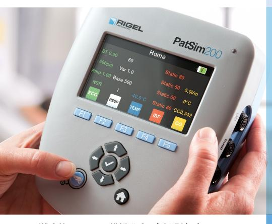
Rigel推出的PatSim200模拟器采用全新设计,实现了更快更高效的患者信号模拟。与其它同类型模拟器不同的是, PatSim使用Home键及调用功能实现测试功能和最常使用序列间的切换,执行测试时无需多次点击和在"树形"等级之间来回滚动菜单。
