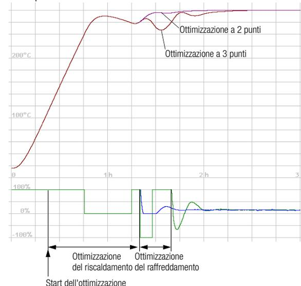
Fig. 2 Profilo di regolazione con auto-ottimizzazione
