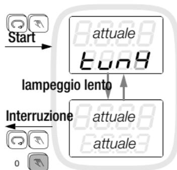
Questa funzione serve a stabilire la dinamica di regolazione ottimale, cioè a determinare i parametri **Pb I**, **Pb II**, **tu** e **tc**.
