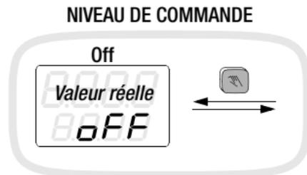
La configuration de la touche
