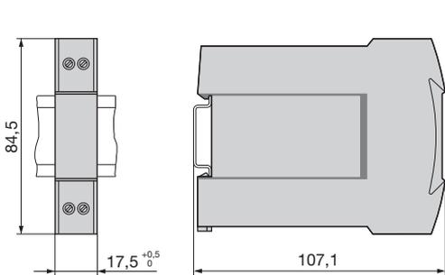
Bild 10. SINEAX TI 807-5.... (N17-Gehäuse) auf Hutschiene (35 x 7,5 oder 35 x 15 mm, nach EN 50 022) aufgeschnappt.
