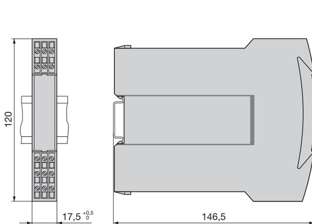
Bild 12. SINEAX TI 807-1.... (S17-Gehäuse) auf Hutschiene (35 x 7,5 oder 35 x 15 mm, nach EN 50 022) aufgeschnappt.
