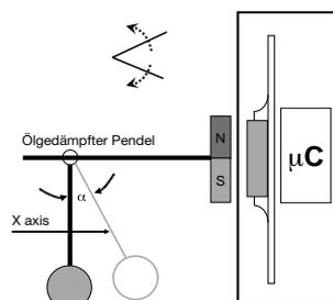
Pendeldämpfung: Durch Ölfüllung
