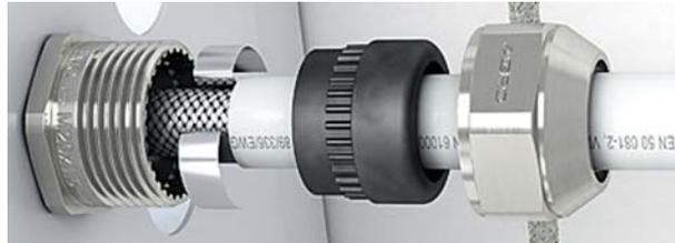
Insérer le ressort de contact avec jeu d'étanchéité dans la partie inférieure et serrer l'écrou de pression avec un outil. Vérifier que le ressort de contact soit bien en contact avec le blindage.
