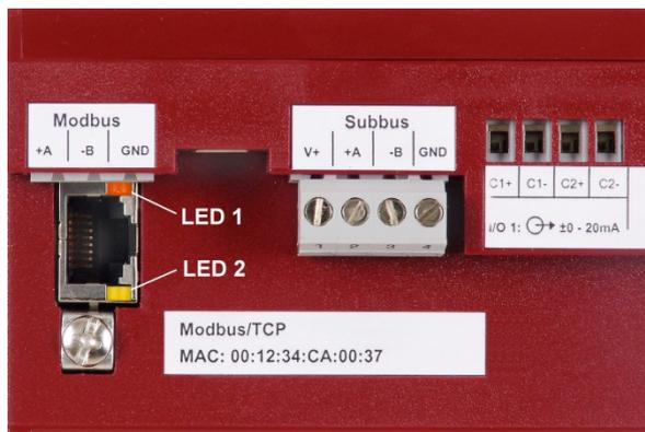
Die Standard RJ45-Buchse dient dem direkten Anschluss eines Ethernet-Kabels. Bei Direktanschluss an einen PC muss ein gekreuztes Kabel verwendet werden.
