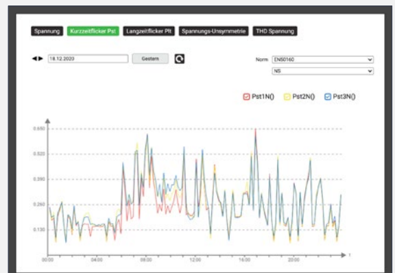
Tagesverlauf des Kurzzeitflickers Pst via Webseite des Gerätes
