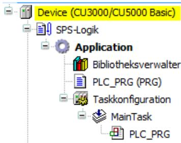
Doppelklick auf **Device (CU3000/CU5000 xxxx)** im Gerätebaum. Die unten gezeigte Ansicht wird geöffnet.
