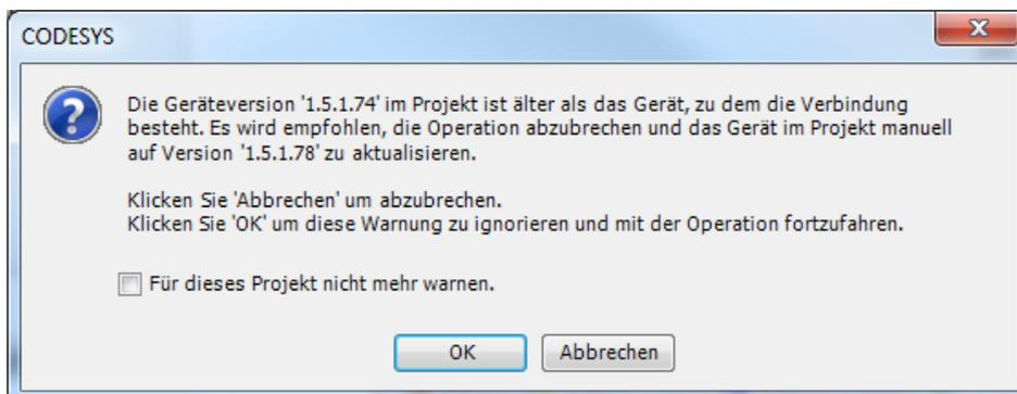
In diesem Fall kann die Gerätebeschreibung des Projektes aktualisiert werden. Dazu muss diese in der CODESYS-IDE installiert werden (siehe [Kapitel 8.2](#)). Danach kann das Projekt aktualisiert werden:
