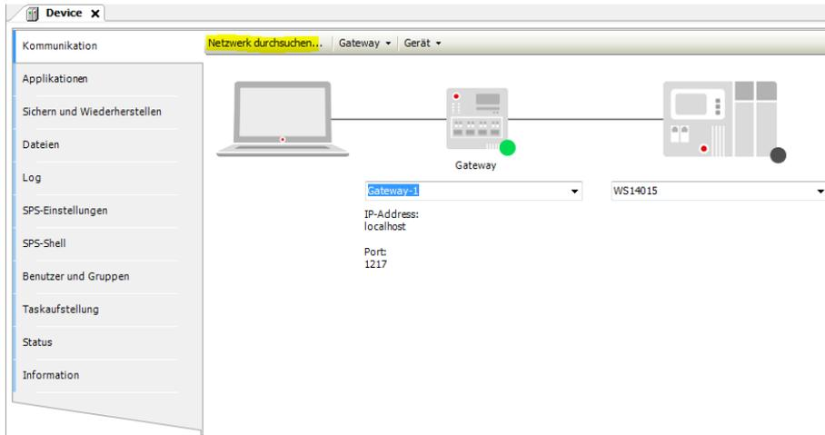
Im Bereich Kommunikation auf **Netzwerk durchsuchen** klicken. Es wird eine Liste mit allen Geräten angezeigt, welche vom PC aus sichtbar sind.
