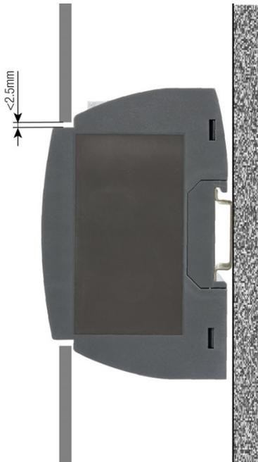
Das Gerät kann auch so montiert werden, dass die Front des Gerätes durch eine Öffnung in der Abdeckung herausragt. So werden Bedientasten und Display zugänglich. Mit dem unten dargestellten maximalen Ausschnitt ergibt sich bei zentrischer Montage ein Spalt zwischen Abdeckung und Gerät, der auf jeder Seite 2.5mm nicht überschreitet.
