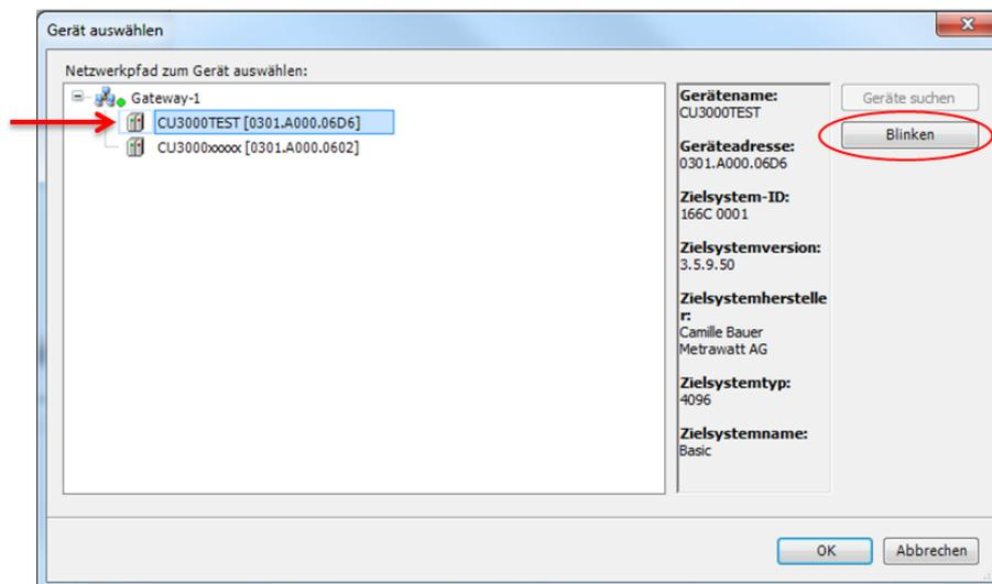
Das Gerät wird am einfachsten über seinen Hostnamen identifiziert, welcher ihm in den Kommunikationseinstellungen der Ethernet-Schnittstelle zugewiesen wurde. Im oben angezeigten Beispiel ist dies der Hostname **CU3000TEST**, das andere Gerät hat immer noch die initiale Einstellung CU3000xxxxx.
