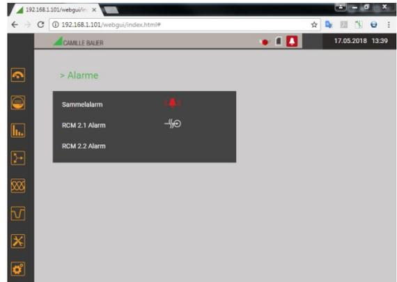
Gerät mit RCM-Modul: Alarm via WEB-GUI
