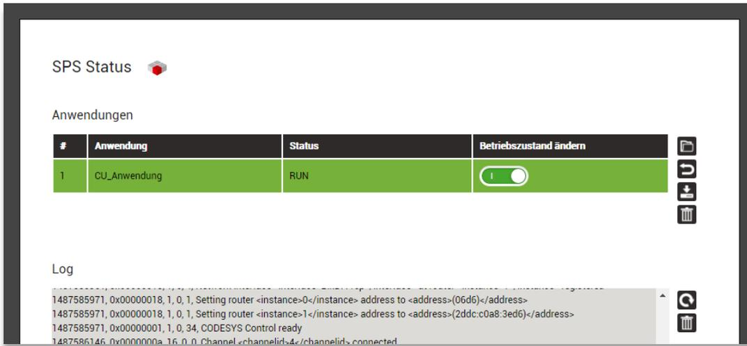
Mit Hilfe des Schalters in der Spalte „Betriebszustand ändern“ kann die Anwendung jederzeit gestoppt und wieder gestartet werden.
