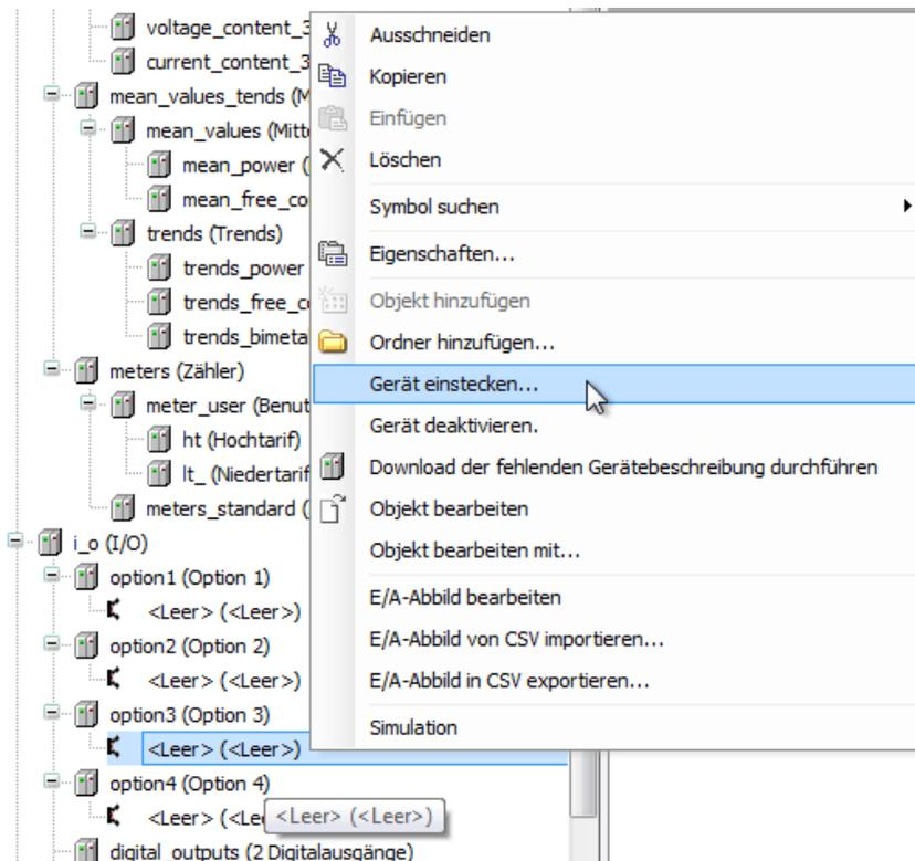
Die korrekte Modulooption auswählen und mit „Gerät einstecken“ bestätigen.
