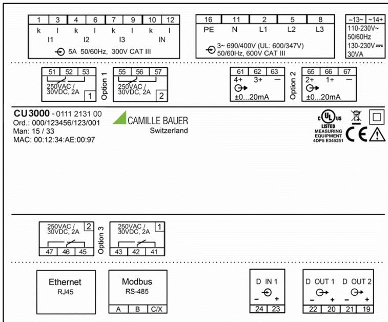
Typenschild eines CU3000 mit
