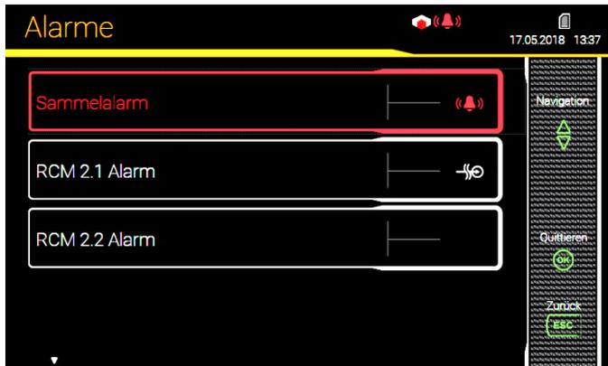
Gerät mit RCM-Modul: Alarm via lokales GUI
