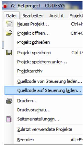
Das via CODESYS-IDE erstellte Projekt kann im Gerät gespeichert werden. Dies erleichtert die Änderung der Anwendung im Feld.
