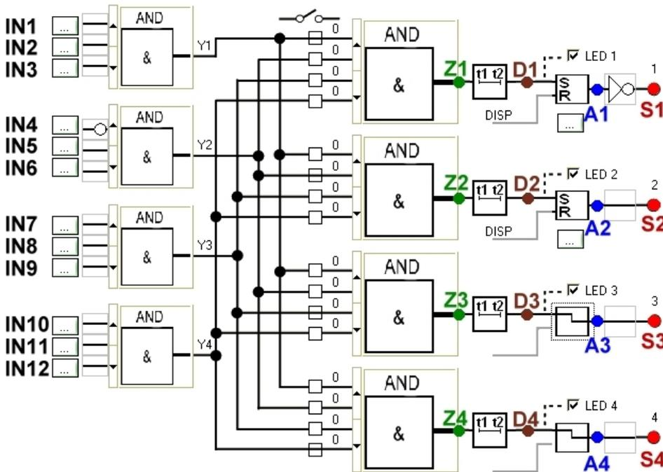
**Logikzustände setzen:** Für alle unter SIM\_OUT1 ausgewählten Kanäle kann ein Zustand vorgegeben werden
