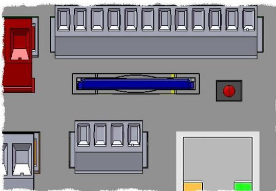
Die rote LED der neben der SD-Card angeordneten Taste signalisiert, dass der Logger aktiv ist. Während des Schreibens auf die SD-Card wird die LED kurz dunkel.
