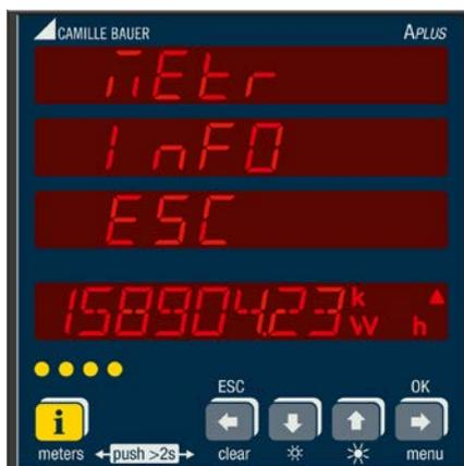
**Zählerablesung:** Durch langes Drücken der Taste **i** wird der Bedienmodus für die Ablesung aller Zählerstände via Zeile 4 gestartet. Dieser Modus wird automatisch nach 30s ohne Tastendruck oder über die Taste **ESC** beendet. Während dieser Modus aktiv ist, wird auf den Zeilen 1 bis 3 keine Messwert-Information angezeigt.
