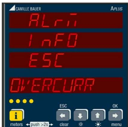
**Alarm-Anzeige:** Durch kurzes Drücken der Taste **i** wird ein Bedienmodus gestartet, welcher die Anzeige von Alarmzustands-Texten und die Quittierung von Alarmen via Zeile 4 ermöglicht. Sind keine Alarmer konfiguriert wird "No LED used" angezeigt und der Modus wieder beendet. Sonst wird der Modus automatisch nach 30s ohne Tastendruck oder über die Taste **ESC** beendet. Während dieser Modus aktiv ist, wird auf den Zeilen 1 bis 3 keine Messwert-Information angezeigt.
