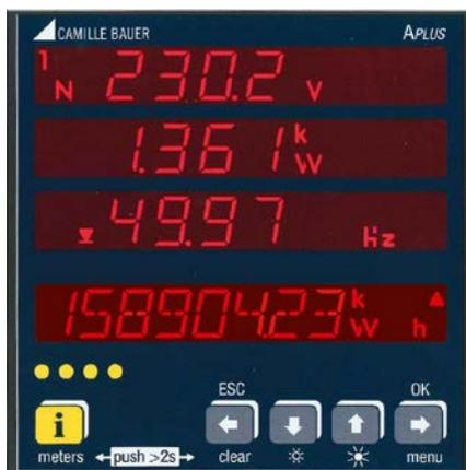
**Messwertanzeige:** Ist der normale Bedienmodus des Gerätes. Mit Hilfe der Navigationstasten können die verschiedenen Messwertbilder angewählt werden. Abhängig vom eingestellten Anzeige-Modus und der überwachten Netzform stehen unterschiedliche Messwertbilder zur Verfügung.
