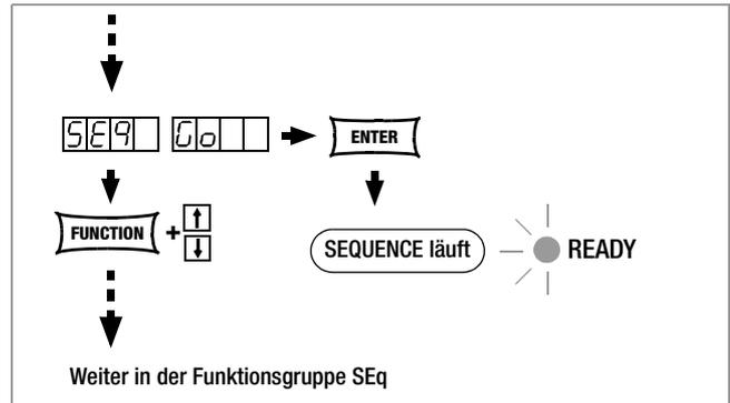
Bild 4.7.3 h Vorbereiten eines SEQUENCE-Starts
