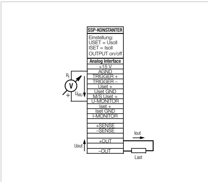
Bild 5.5 Verdrahtung Spannungsmonitor
