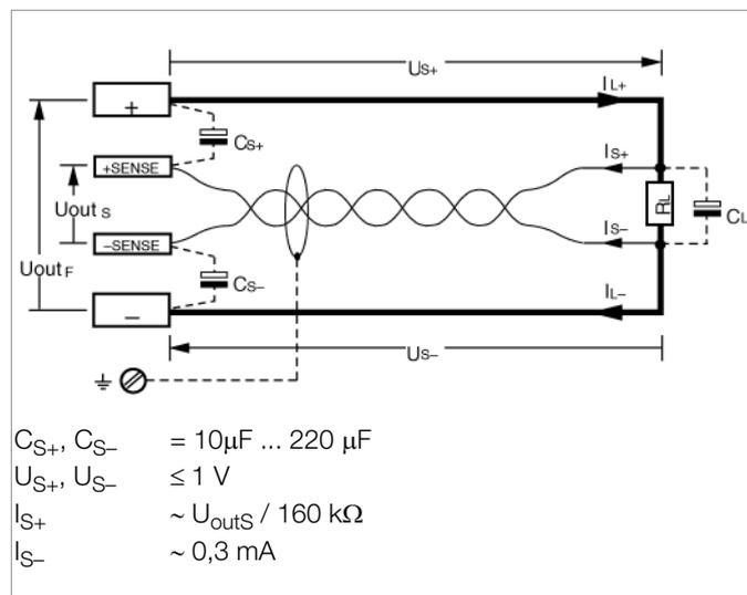
Bild 5.2 Lastanschluss mit Fühlerbetrieb
