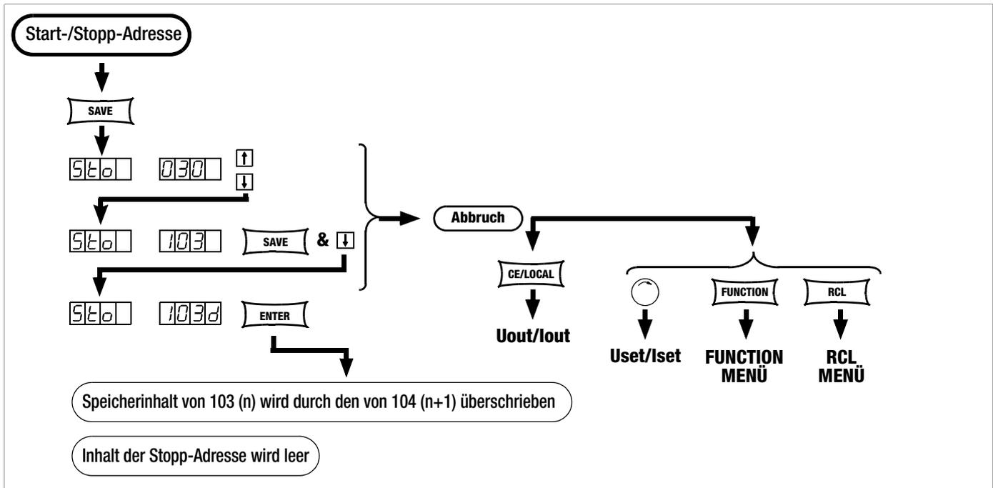
Bild 4.10.5 Löschen eines einzelnen SEQUENCE-Speicherplatzes
