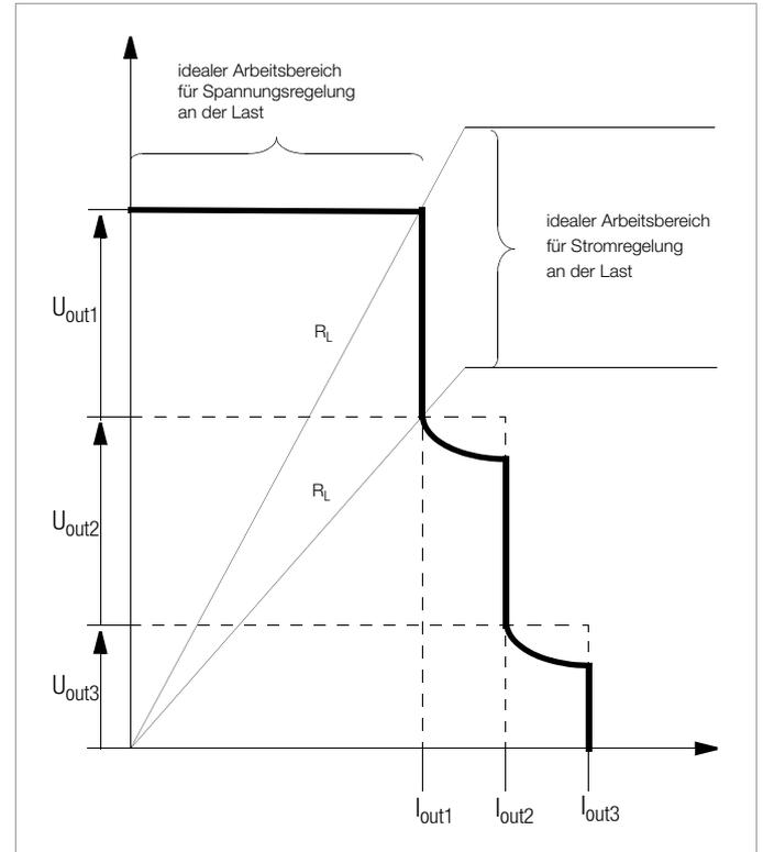
Bild 5.9.1b U / I-Diagramm bei direkter Serienschaltung
