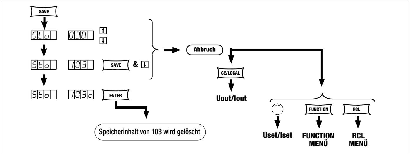
Bild 4.10.6 Löschen des Inhaltes eines einzelnen Speicherplatzes
