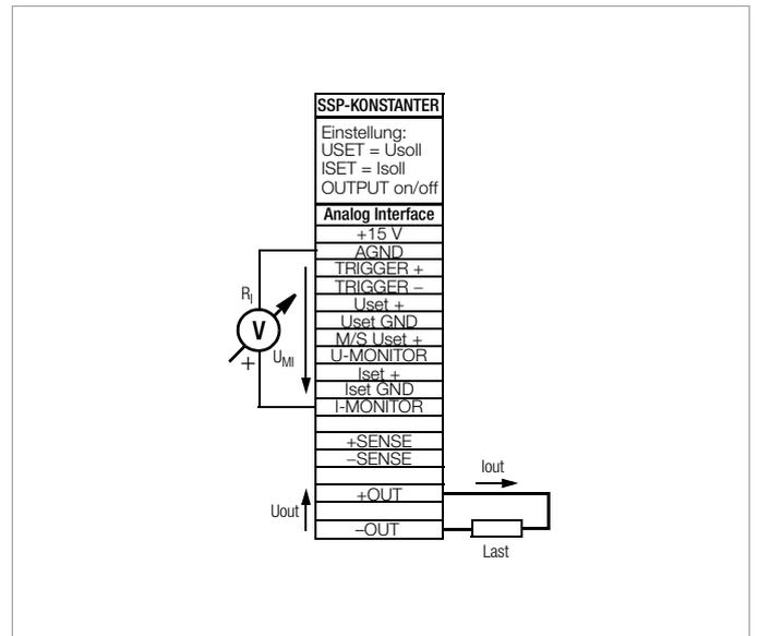
Bild 5.6 Verdrahtung Strommonitor
