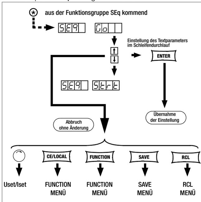
Bild 4.7.3 f Auswahl eines Sequence-Starts oder Schrittsteuerung
