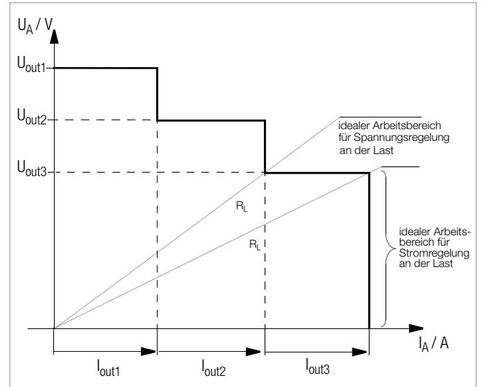
Bild 5.8.1b U / I-Diagramm bei direkte Parallelschaltung
