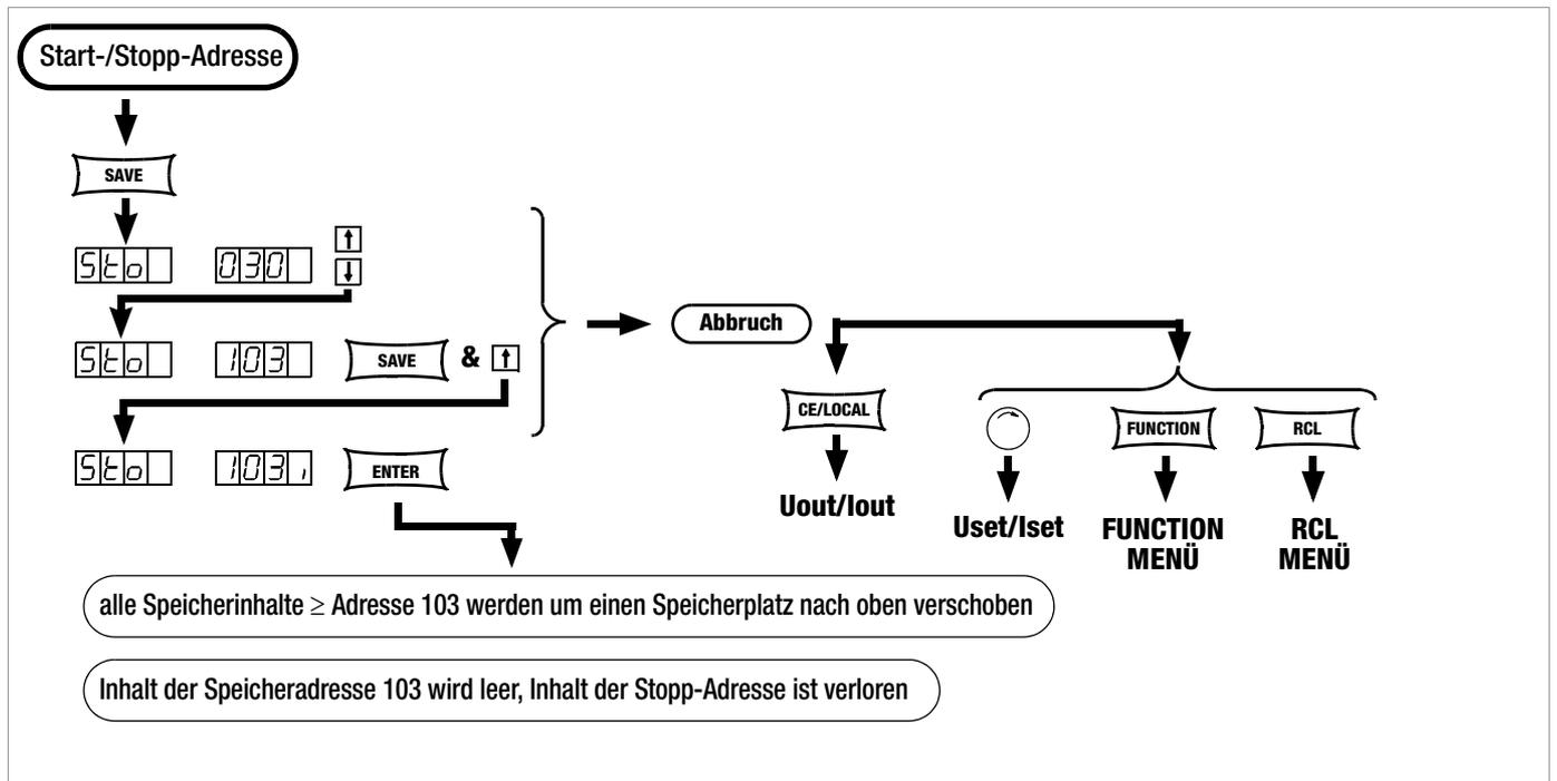
Bild 4.10.4 Einfügen eines leeren Speicherplatzes in einen Speicherbereich
