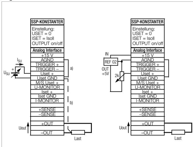
Bild 5.3a Verdrahtung für Spannungssteuerung durch externe Spannung
