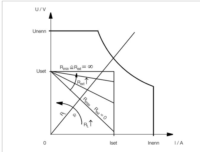
Bild 5.10 a Abhängigkeit der Ausgangsspannung von der Belastung
