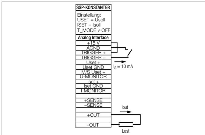
Bild 5.7 a Ansteuerung des TRIGGER-Eingangs durch einen Schaltkontakt
