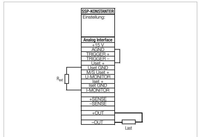
Bild 5.10 c Verdrahtung zum Variieren des Innenwiderstandes
