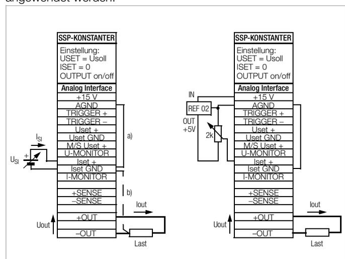
Bild 5.4a Verdrahtung für Stromsteuerung durch externe Spannung
