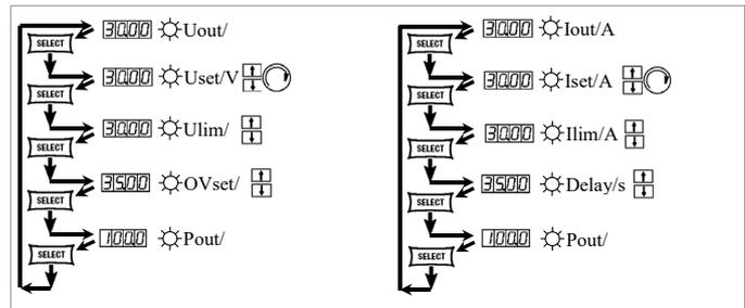
Bild 4.8.1 Anzeigenumschaltung mit der SELECT-Taste
