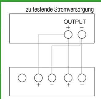
Fernfühleranschlussbuchsen sowie Trigger-Anschlussbuchse sind vorhanden. Sobald die Fernfühler angeschlossen sind, schaltet das Gerät automatisch auf Fühlerbetrieb um.
