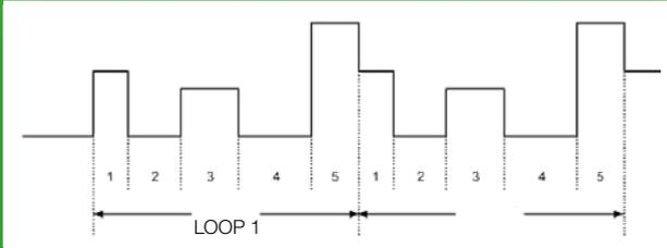
Umfangreiche sequenzielle Testfunktionen; mit der kleinsten Schrittweite von 10 µs und der größten Schrittweite von 100 000 s. Zyklische Adressen können frei eingestellt werden und eine Sequenz kann mit einer anderen Sequenz verbunden werden, um noch komplexere Testprozeduren durchzuführen.
