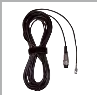
Sensore di temperatura Pt100 esterno per la misura separata delle temperature del sensore di irraggiamento e di quella sul retro del modulo per una maggiore accuratezza
