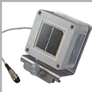
Kalibrierter Einstrahlungssensor monokristallin nach IEC / EN 60904-2 mit integriertem Temperatursensor Pt1000, 10 m Anschlusskabel
