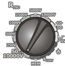
Posizionare il selettore su una delle funzioni  $R_{iso}$ . Selezione della tensione di prova, posizione **50...10000 V**; incremento della tensione come segue:
