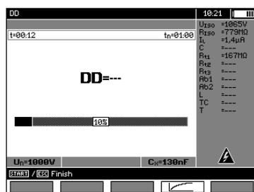
Sia durante che dopo la misurazione è possibile passare dalla visualizzazione dei risultati al diagramma e viceversa, premendo il tasto **F4** .
