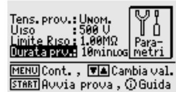
Selezionando per il parametro tempo l'impostazione "min log", lo strumento memorizzerà, per la durata di prova specificata, automaticamente 30 risultati, ad intervalli di tempo da 4 secondi a 2 minuti. Così si riesce a realizzare una funzione data logger per un periodo compreso tra 2 e 60 minuti. In questa modalità, il tempo residuo della misura in corso verrà indicato in minuti invece che in secondi.
