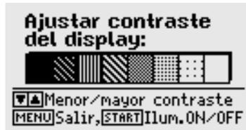
\* La iluminación de fondo se desconecta automáticamente transcurridos aproximadamente 2,5 minutos sin pulsar ninguna tecla. Pulsando una de las teclas del comprobador, se activará para otros 2,5 minutos.
