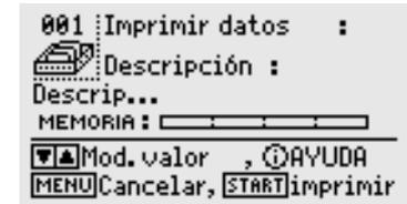
\* Una vez iniciada la secuencia de impresión, únicamente puede cancelarse por medio del selector de funciones. Si no funciona la impresora, se genera el correspondiente mensaje de error. En tal caso, es imprescindible iniciar nuevamente la secuencia de impresión.
