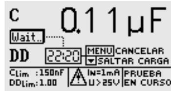
Una vez determinada la capacidad, el comprobador automáticamente continua determinando la descarga dieléctrica DD (dielectric discharge). Esta operación tardará unos 30 minutos de tiempo. La medida se puede cancelar en cualquier momento pulsando la tecla MENU, visualizando en tal caso únicamente el valor de capacidad.
