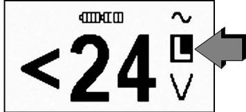
**Messung in Stromkreisen mit RCD ohne Auslösung**
