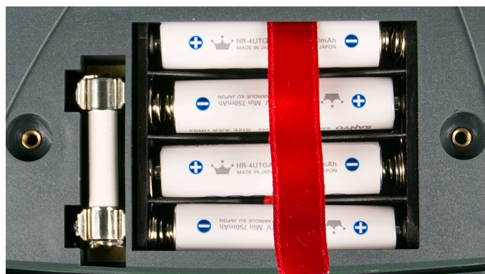
Figura 6.1 Polarità corretta delle batterie
