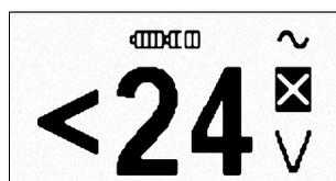
Figure 3.1 Tension < 24 V (représentation en bref).
