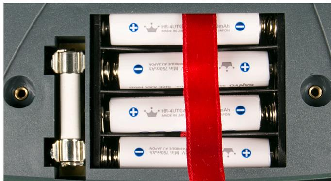
Figure 6.1 Polarité correcte des piles
