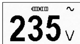
Figure 3.4 Mesure de la tension (représentation en bref).
