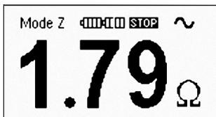
Figure 3.10 Affichage du dépassement de température – symbole STOP
