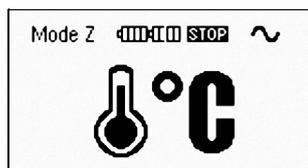
Imagen 3.11 Sobretemperatura, display pulsando START
