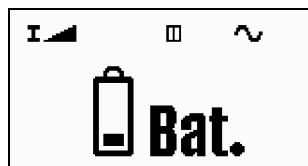
Figure 3.9 État des piles après avoir appuyé sur START
