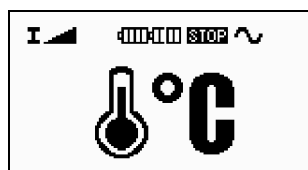
Imagen 3.11 Aviso de temperatura elevada, pulsando START
