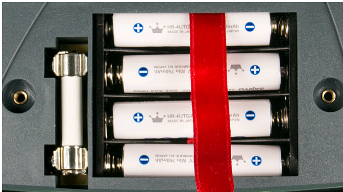
Imagen 3.24 Polaridad de baterías
