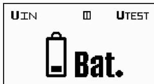
Figura 3.3 Bassa tensione di batteria: segnalazione dopo START
