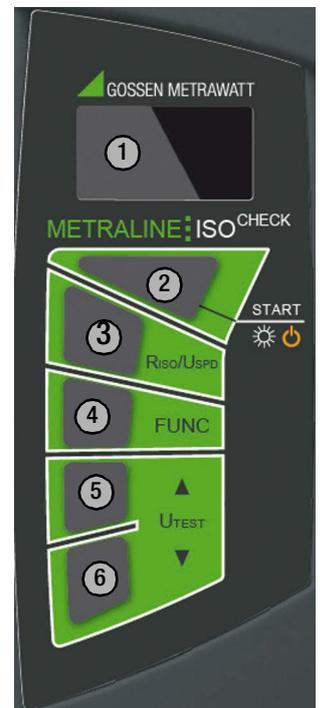
Figura 2.3 Area di comando e display OLED
