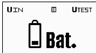
Imagen 3.3 Tensión insuficiente de las baterías: pulsando la tecla de START
