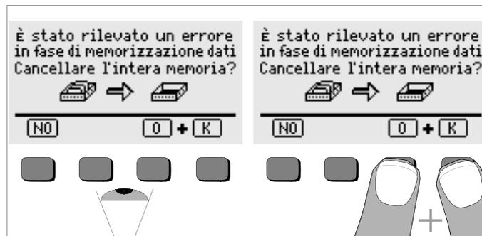
Se il messaggio sopra riportato appare all'accensione dello strumento, avete la possibilità di salvare tutti i dati sul PC prima di cancellare la banca dati per eliminare l'errore.
