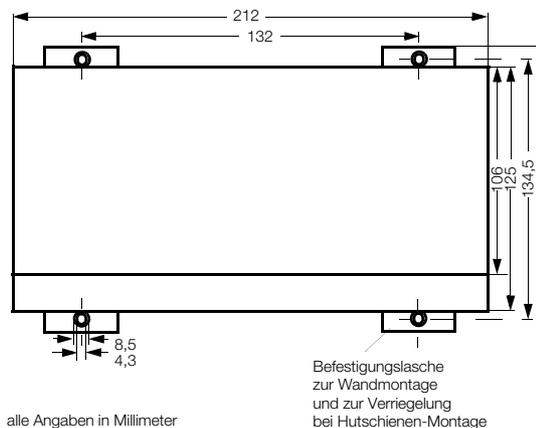
Bild 1 Abmessungen
