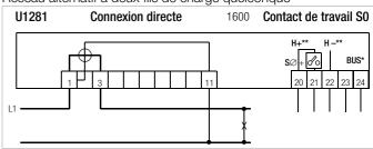
Réseau alternatif à quatre fils de charge quelconque
