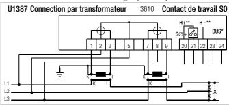
Réseau alternatif à quatre fils de charge quelconque
