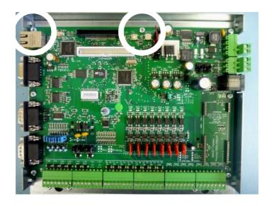
Stecken Sie anschließend die LON-Platine mittig in den Expansion Slot. Bitte vorsichtig einstecken und darauf achten, dass die Pins alle in die entsprechenden Buchsen laufen.
