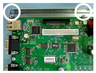
Befestigen Sie dann die LON-Erweiterungsplatine mit den beiden M3-Schrauben.
