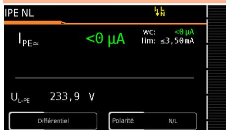
La valeur de mesure est automatiquement calculée dans un espace de temps défini. Le contrôle séquentiel se poursuit ensuite automatiquement.
