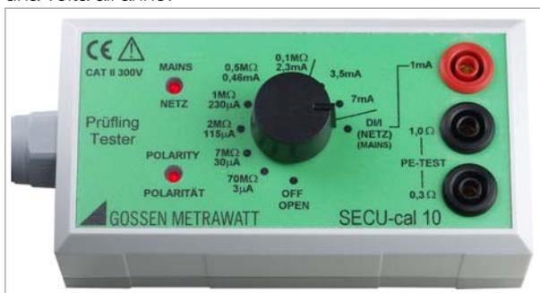
Il controllo deve comprendere tutti i valori limite per le verifiche richieste dalle norme DIN VDE, tra cui resistenza del conduttore di protezione, resistenza di isolamento, corrente dispersa equivalente, corrente differenziale e/o di contatto o corrente dispersa sull'involucro.
