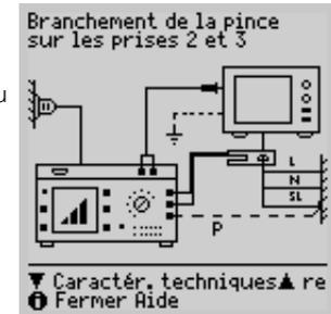
P : câble de potentiel pour mesure quadripolaire.
