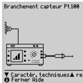
Avec un capteur Pt100 ou Pt1000 (réglage de base) connecté aux bornes 1 et 2, vous pouvez mesurer des températures de  $-200^{\circ}\text{C}$  à  $+850^{\circ}\text{C}$ .
