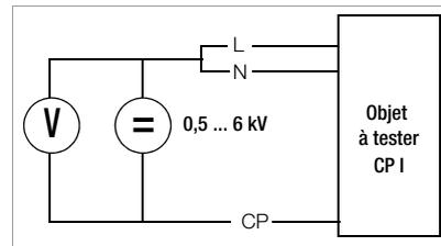
Si la classe de protection II est détectée, l'essai s'effectue entre les conducteurs court-circuités L-N de la prise d'essai et la sonde (connexion 4-5).
